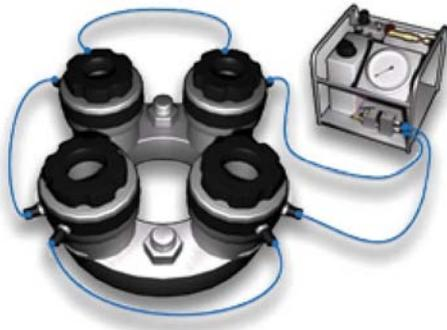
Montieren Sie einen Vorspannzylinder auf jedem zweiten Bolzen. Beaufschagen Sie das System mit dem „Druck 1“, wie auf dem Datenblatt angegeben.
