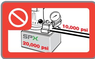
Überprüfen Sie den maximalen Betriebsdruck der Hydraulikpumpe. Verwenden Sie Pumpen mit 20.000 psi niemals mit einem System, das Komponenten mit 10.000 psi enthält (Schläuche, Anschlüsse, Ventile, Werkzeuge, etc.).
