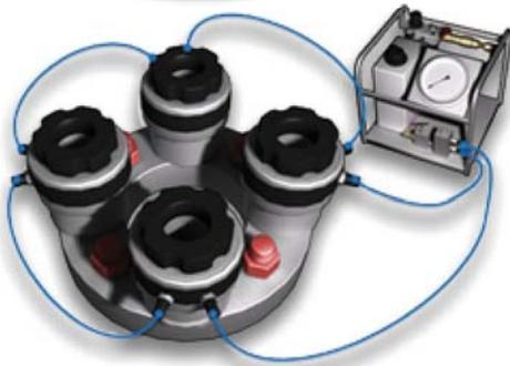
Setzen Sie die Vorspannzylinder auf die verbleibende Hälfte der Bolzen auf und beaufschlagen Sie das System mit dem „Druck 2“, wie auf dem Datenblatt angegeben.
