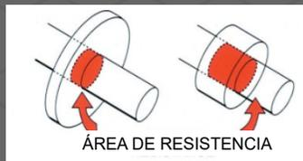
**Para extractores manuales accionados por tornillo:** El tornillo del extractor debe tener al menos la mitad del diámetro del eje de la pieza que se va a extraer.
