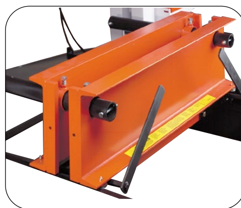
El ancho se ajusta de 102 mm a más de 686 mm; se fija con pernos de bloqueo.
