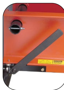
Levier abaissant le lit pour le pressage, le relevant pour le roulage.
